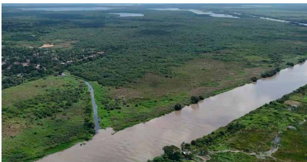
Figura 6: Canal del Dique en Sector Puerto Badel y Dársena de Juan Gómez. Nótese la incidencia del ángulo de conexión en la inhibición del caudal sólido (sedimentos) que lleva el cuerpo léntico principal al secundario Fuente: (Escobar, 2026)
